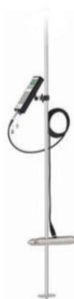
Un signal d'écho dépendant de la taille et de la forme des particules est renvoyé aux transducteurs, il est réceptionné puis traité par un processeur numérique DSP. Ce processus est réitéré après une courte pause. Le deuxième écho réceptionné est également numérisé.
